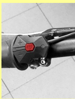
2. Zapnout řídicí jednotku
