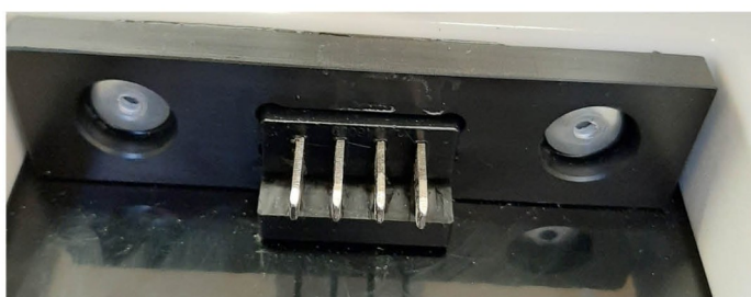
Dokovací konektor v nášlapu koloběžky
