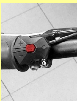
2. Zapnout řídicí jednotku
