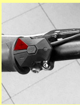
3. Zvolit stupeň dopomoci pomocí tlačítka +/- (st.5 je nejvyšší)
